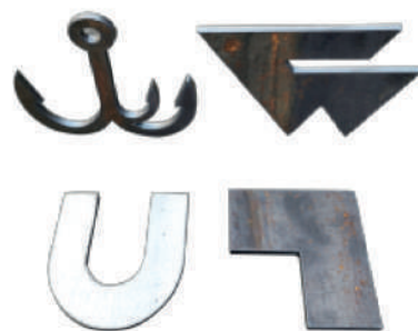
Échantillon de découpe au plasma
